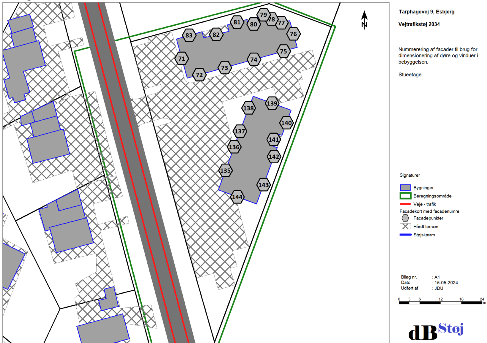
Figur 16: Facadeberegningpunkter med nummerering, stueetage.
