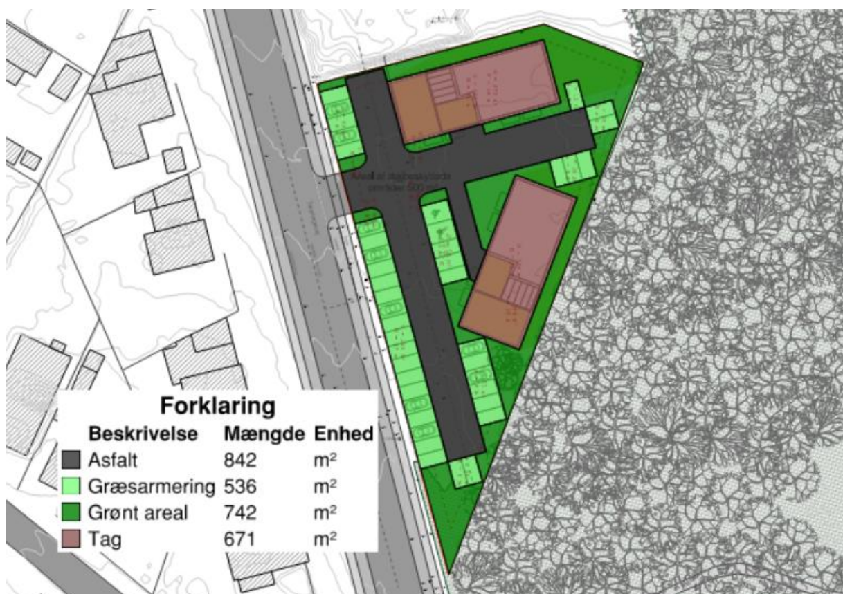
Figur 6: Opmåling af befæstelsesgrad på projektmatriklen med udgangspunkt i projektforslag for bebyggelsen dateret d. 6. juni 2024.
