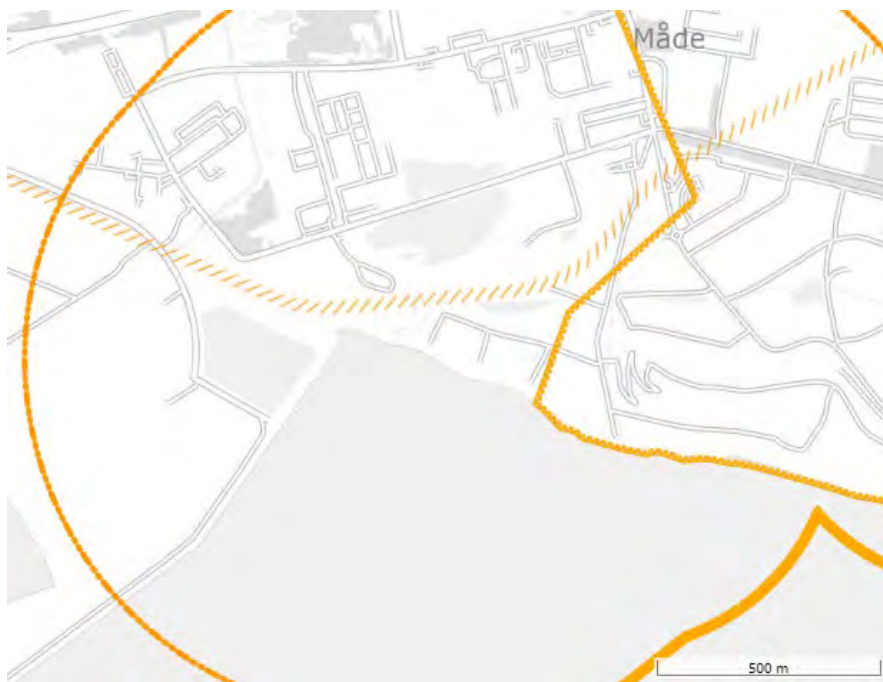
Figur 3.11 - Isolinjer omkring vindmøller (orangeprikket linje) skydebane (orange takket linje) virksomhed (tyk orange linje). Indenfor planområdet er ligeledes en isolinje for jernbane (orange skraveret flade). Nord er op.
