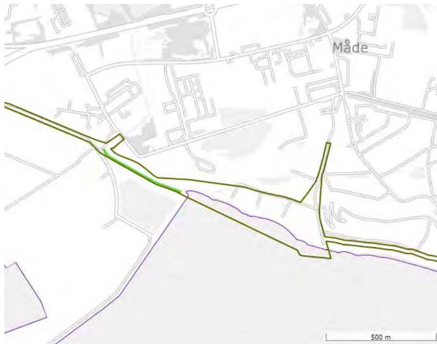
Figur 3.9 - Den sydlige del af planområdet er udlagt som stormflodssikringszone (mørk grøn linje) og område med risiko for kysterosion (lilla linje). I den vestlige del af planområdet er ligeledes udpeget til kystbeskyttelse og havdige (grøn linje). Nord er op.
