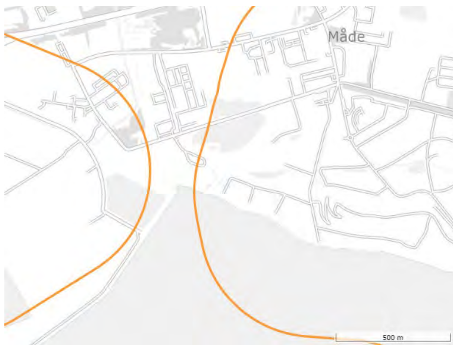
Figur 3.1 - Retningslinje AS.6 Isolinde for deponi. Isolinder omkring deponier (orange linje). Nord er op.
