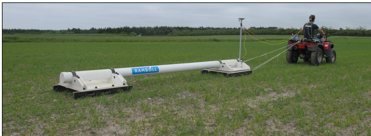
Figur 16 Instrument setup, placeret på en slæde som trækkes bag en ATV.
