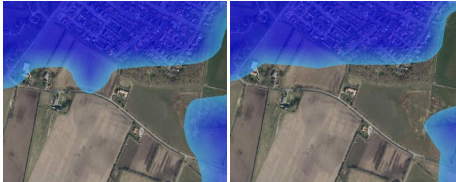
Figur 3.7: Modelleret 10-års hændelse hhv. 2-års hændelse for det terrænnære grundvand for fjern fremtid, fremskrevet ved emissionsscenario RCP8.5, Figurer fra SCALGO /1/
