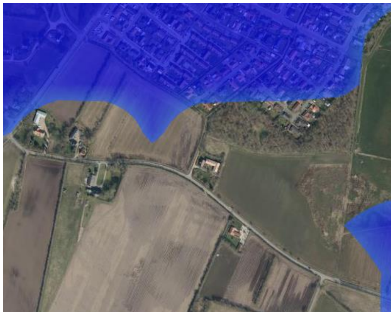
Figur 3.8: Modelleret 10-års hændelse for det terrænnære grundvand for fjern fremtid, fremskrevet ved emissionsscenarie RCP8.5, Figurer fra SCALGO /1/
