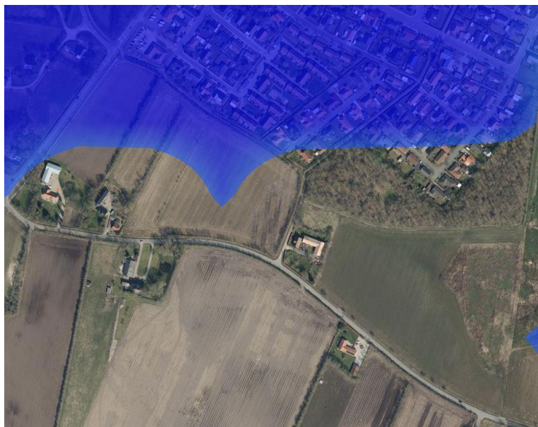
Figur 3.9: Modelleret 10-års hændelse for det terrænnære grundvand for nær fremtid, fremskrevet ved emissionsscenarie RCP4.5, Figurer fra SCALGO /1/
