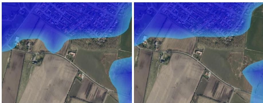
Figur 3.6: Modelleret 10-års hændelse hhv. 2-års hændelse for det terrænnære grundvand for nær fremtid, fremskrevet ved emissionsscenario RCP4.5, Figurer fra SCALGO /1/
